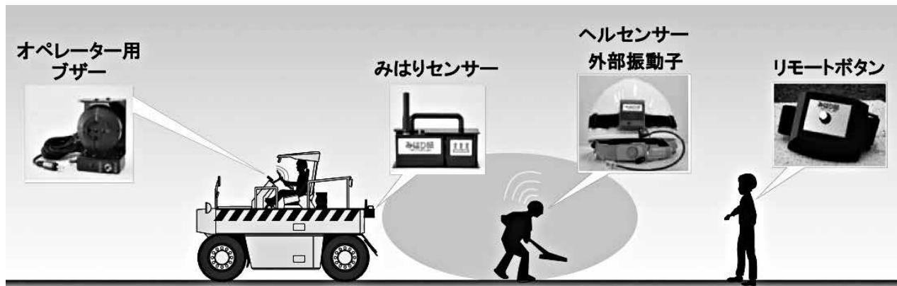
『みはり組』は、重機の危険範囲内の作業員に、**音と振動で危険を知らせる警報補助装置**です。作業に集中していて危険を感じ取れないことは、残念ながら起こってしまう可能性があります。そして、雨や広い場所での強風、ほかの重機などのノイズ等、厳しい条件が重なると、さらに危険度は高まります。これらの条件で作用されにくい近赤外線を使用し、作業員の安全確保、簡単に使えます。
