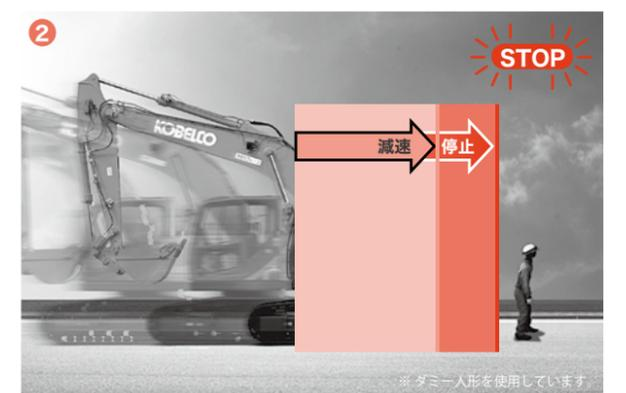
1 センサが人や障害物を検知すると、キャブ内のマルチディスプレイに検知エリアを表示。黄色が減速エリア、赤色は停止エリア内での検知を示します。停止エリアで検知した際はアラームと警告表示でもお知らせします。
