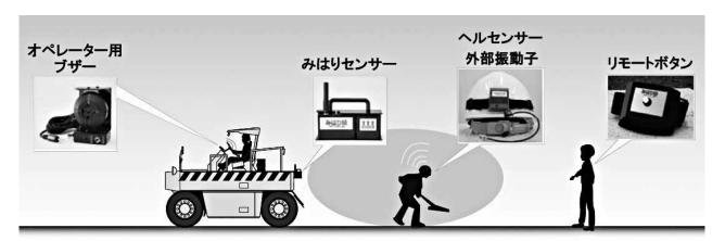
『みはり組』は、重機の危険範囲内の作業員に、<mark>音と振動で危険を知らせる警報補助装置</mark>です。作業に集中していて 危険を感じ取れないことは、残念ながら起こってしまう可能性があります。そして、雨や広い場所での強風、ほかの 重機などのノイズ等、厳しい条件が重なると、さらに危険度は高まります。これらの条件で作用されにくい近赤外線 を使用し、作業員の安全確保、簡単に使えます。
