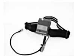
ヘルセンサー(作業員側) 赤外線受信+電波発信機
