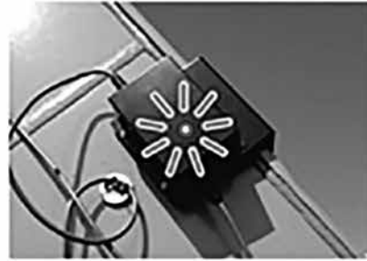
傾斜検出センサー〈光(LED)で警報〉
