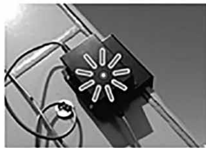
傾斜検出センサー<光(LED)で警報>
